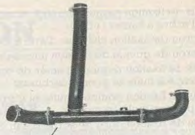
Tuyaux d'amenée et de retour de l'huile moteur au radiateur
