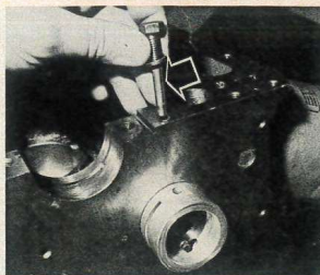
Mise en place de la bague entretoise d'arbre à cames. Flèche : vis pignon.
