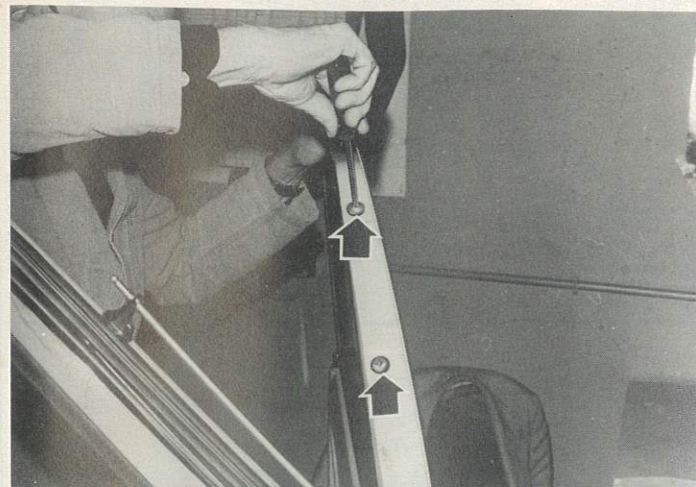
Dépose des vis de fixation sur l'encadrement du déflecteur sur le montant
