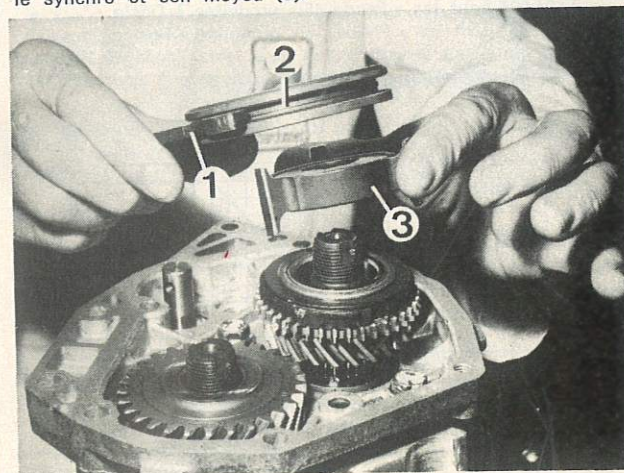
Dépose de la fourchette de 5°
