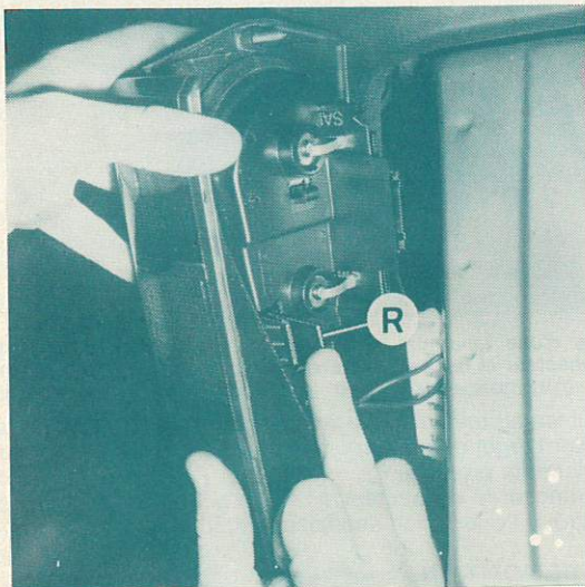
Dépose du boîtier de feux arrière - R. Patte-ressort de maintien du transparent
