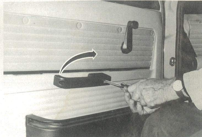
Déposer la poignée de porte avec commande d'ouverture incorporée en la tournant de 90° pour dégager la tringle de commande d'ouverture de porte
