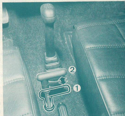
Panda « 4 x 4 » : Levier de boîte de transfert : Position 1 : Traction uniquement sur les roues avant Position 2 : Traction intégrale enclenchée (Photo RTA)
