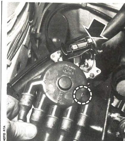
Repose de l'allumeur. Doigt de distribution en regard du plot du cylindre en allumage.
