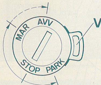
Combiné contact antivol-démarrage
