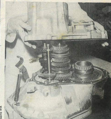
Dépose du carter de pignonnerie
