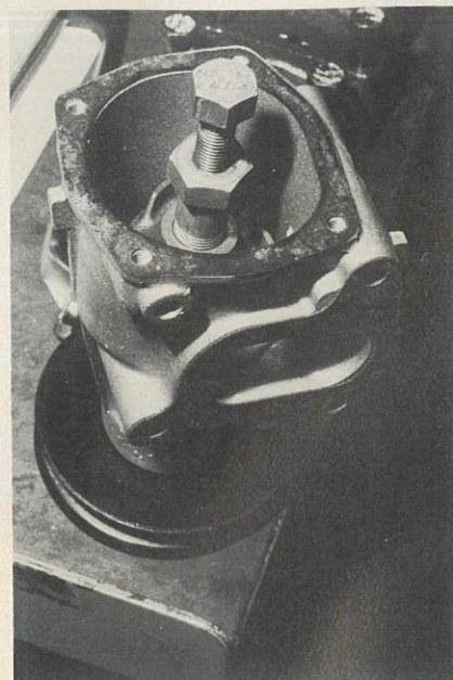
Dépose de la turbine de pompe à eau à l'aide d'un extracteur.
