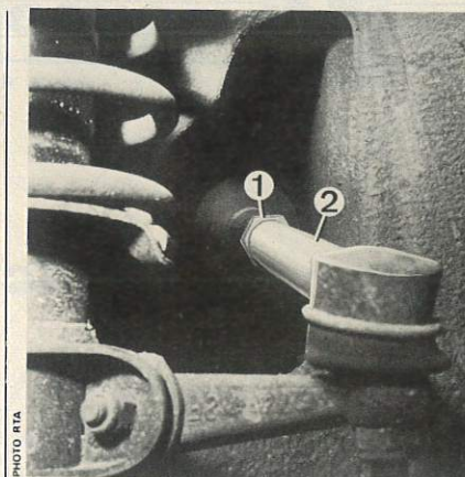
Réglage du pincement 1. Ecrou de blocage - 2. Bielle de réglage.
