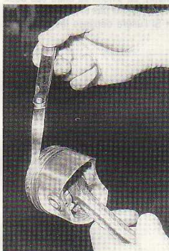
Contrôle du jeu des segments dans leurs gorges.
