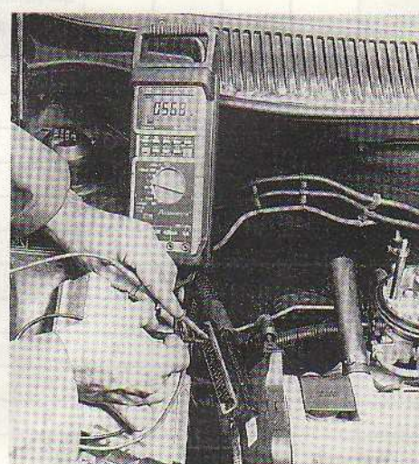
Contrôle du régulateur de ralenti entre les bornes 3 et 21 du connecteur du calculateur.
