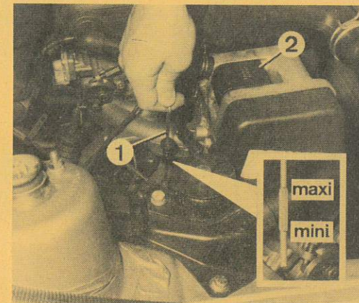
Contrôle du niveau d'huile-moteur 1. Jauge - 2. Bouchon d'orifice de remplissage (Photo RTA)
