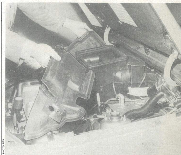
Dépose de la garniture insonorisante du compartiment moteur
