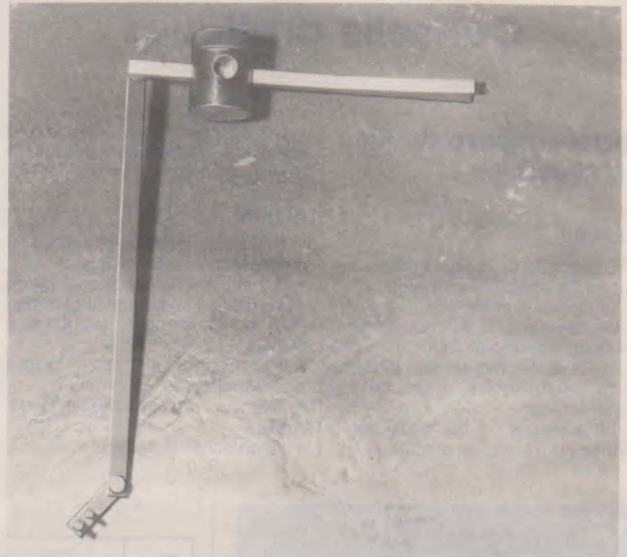
Outil de réglage de la tension de courroie de distribution (Fiat 1860745100)
