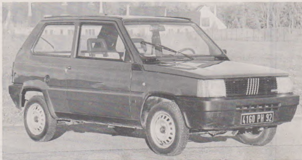
L'adoption du moteur « Fire » et de la suspension « Omega » s'est accompagné de retouches pour la carrosserie. Ici une 750 à moteur 769 cm 3 .
