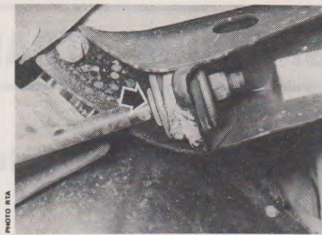
Réglage de la chasse (par interposition de rondelles calibrées)
