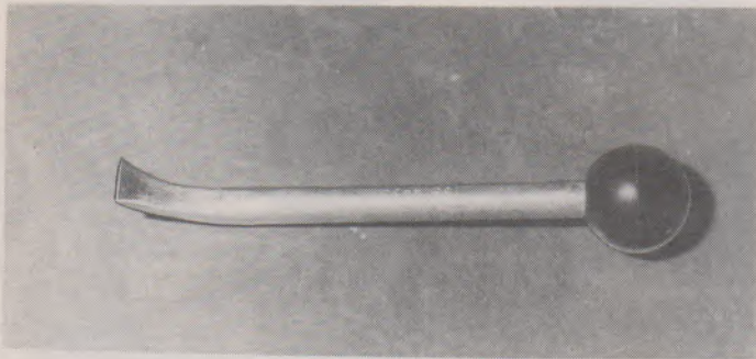
Compresseur de poussoir pour réglage du jeu aux soupapes (Fiat 1860443000)
